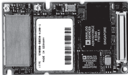
Figura 1.3 – Il modulo Siemens XT75 dotato di runtime Java ME, profilo IMP-NG e Location API.
